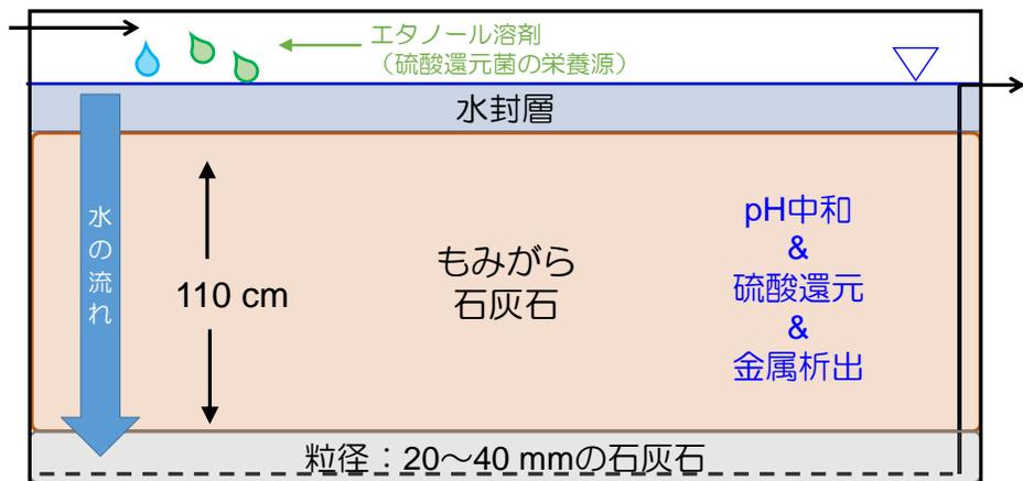
パッシブトリートメント実証試験の反応概念図
