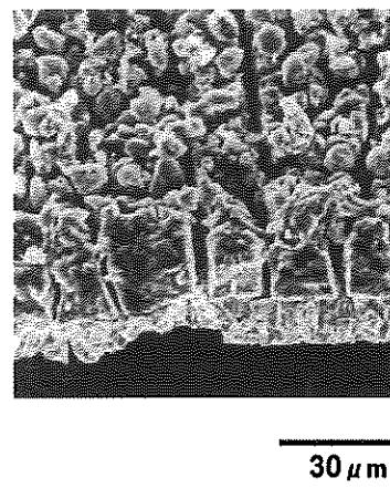
図8 電解共析したスズ合金負極の1回目の充放電後の断面<sup>27)</sup>
